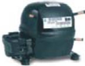
Su principal función es succionar el fluido refrigerante a baja presión de la línea de succión, y comprimirlo en dirección al condensador a alta presión y alta temperatura en la fase gaseosa (vapor sobrecalentado).
