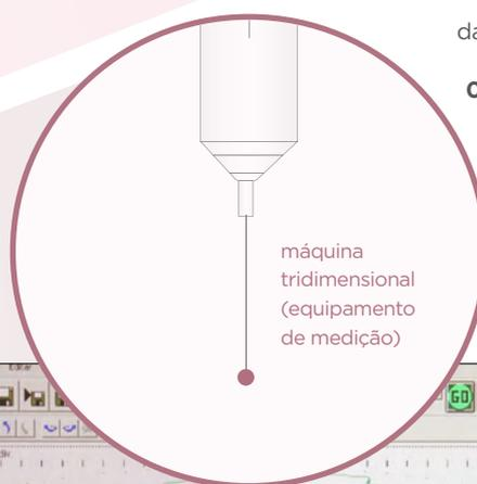
A margem de erro da **máquina tridimensional** da Metrologia da Tecumseh é de **0,4 µm**. Ou seja, divide-se 1 mm em 10.000 partes e fica com 4.
