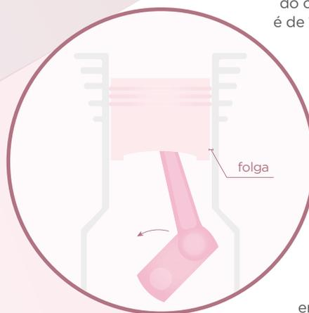
A **folga no cilindro/pistão** do compressor TA<sup>2</sup> é de **10 µm**. Ou seja, divide-se 1 mm em 100 partes e fica com 1.
