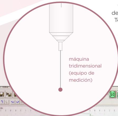
El margen de error de la **máquina tridimensional** de Metrología de Tecumseh es de **0,4  $\mu\text{m}$** . O sea, se divide 1 mm en 10.000 partes y se toman 4.
