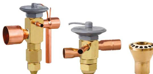
La elección del tipo de ecualización de la VET dependerá de su aplicación. Las VET con ecualización interna deben limitarse en evaporadores con único circuito (en los que la caída de la presión no supere los 2 °C si se la convierte por medio de escala P<sub>x</sub>T). Podemos tener como referencia la **tabla 1** (abajo) para los valores máximos recomendados, como caída de presión para utilización de la VET con ecualización interna.
