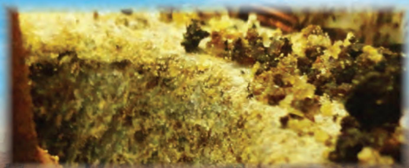
*Amostra de alumínio retirada de compressores danificados por fluidos refrigerantes contaminados*
