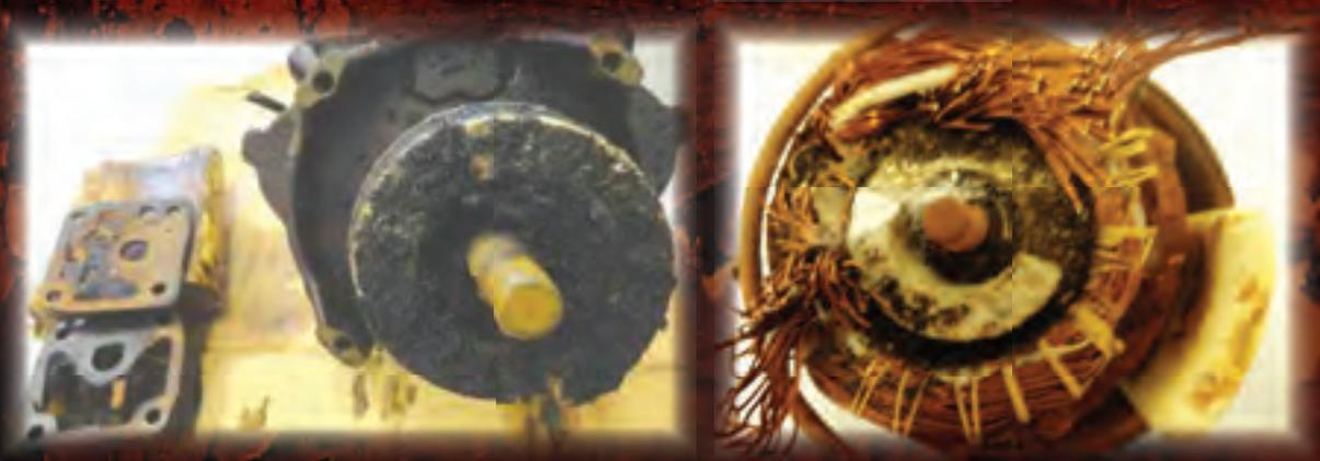
*Peças de compressores danificadas por refrigerantes contaminados*
