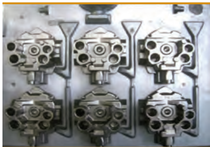
Piezas producidas por fundición de Tecumseh para el mercado automotriz
