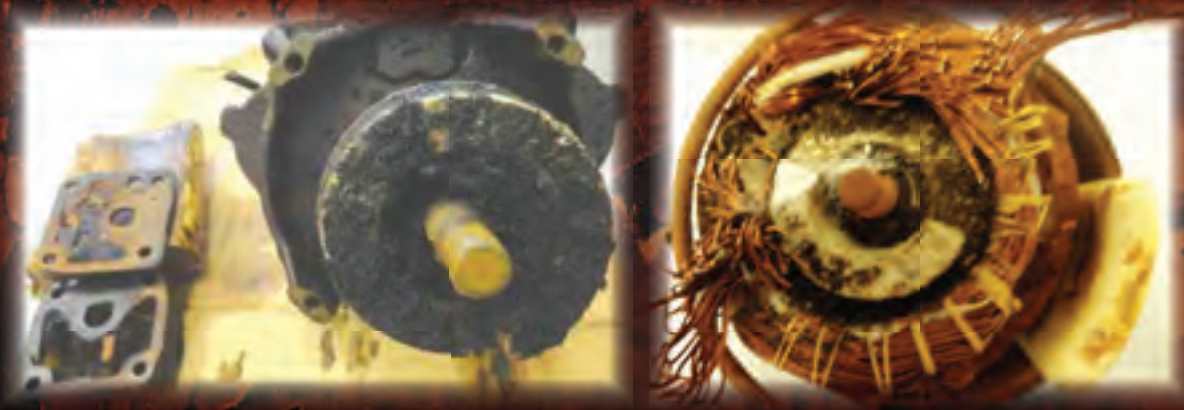
Piezas de compresores dañadas por refrigerantes contaminados
