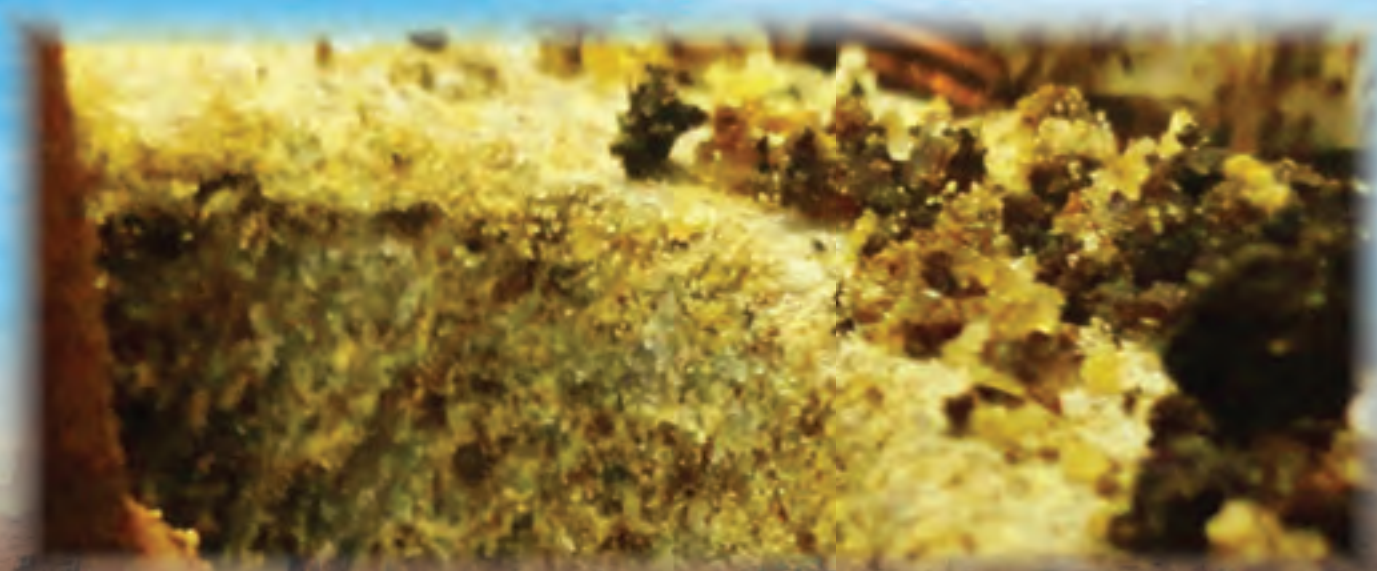
Muestra de aluminio retirada de los compresores dañados por fluidos refrigerantes contaminados
