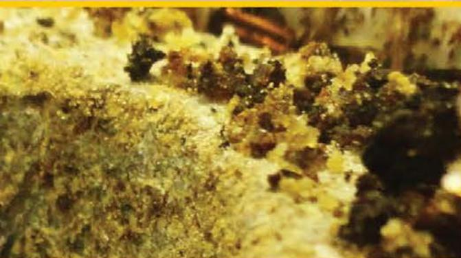
Amostra de alumínio retirado de compressor danificado por fluido refrigerante contaminado
