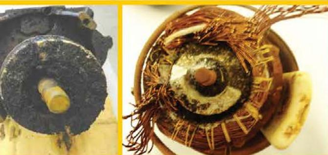
Peças de compressores oxidadas/corroidas
