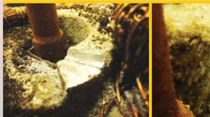
Las principales causas de estos problemas son fluidos refrigerantes incompatibles con el proyecto del compresor que pueden generar supercalentamiento de la bomba y del aceite, especialmente con el gas R-134a contaminado con otros gases clorados.
