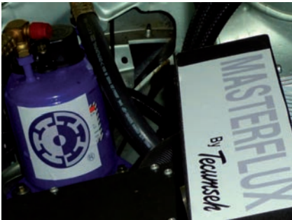
Compresor Masterflux/Tecumseh aplicado en un vehículo eléctrico en el Challenge Bibendum 2010, Rio de Janeiro (Brasil).
