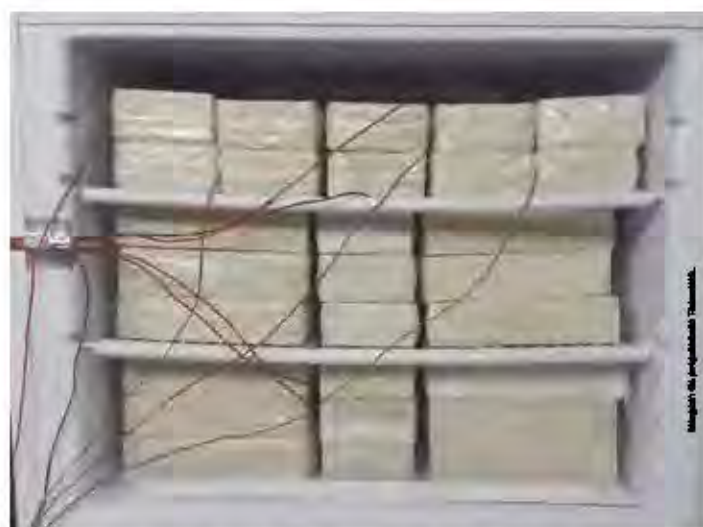
As figuras acima são do compartimento do congelador de um refrigerador duplex completamente carregado para execução de ensaios de armazenamento, consumo e aumento de temperatura.
