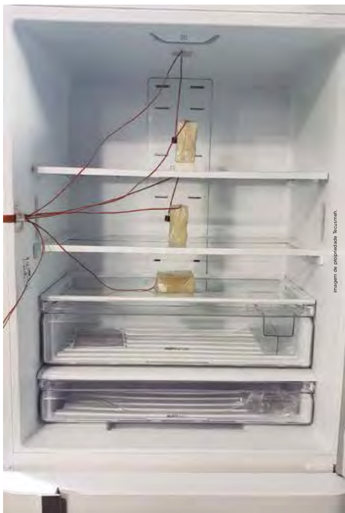
Compartimento de alimentos frescos de refrigerador dúplex cargado con tres cargas monitoreadas para ejecución de ensayos de almacenamiento y pull-down.
