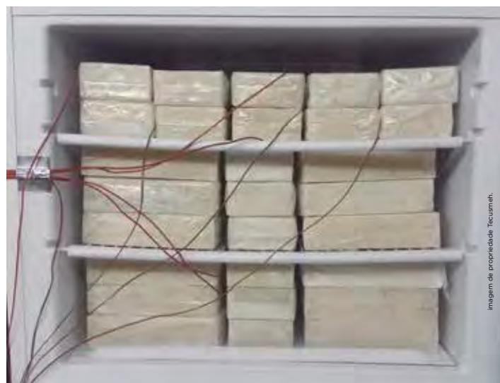
Las imágenes anteriores corresponden al compartimento de congelación de un refrigerador dúplex totalmente cargado para pruebas de almacenamiento, consumo y aumento de la temperatura.
